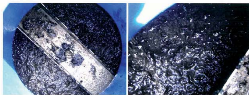
Bild 14 Filtererschöpfung durch Ausbildung Filterkuchen auf dem Zulaufsieb
