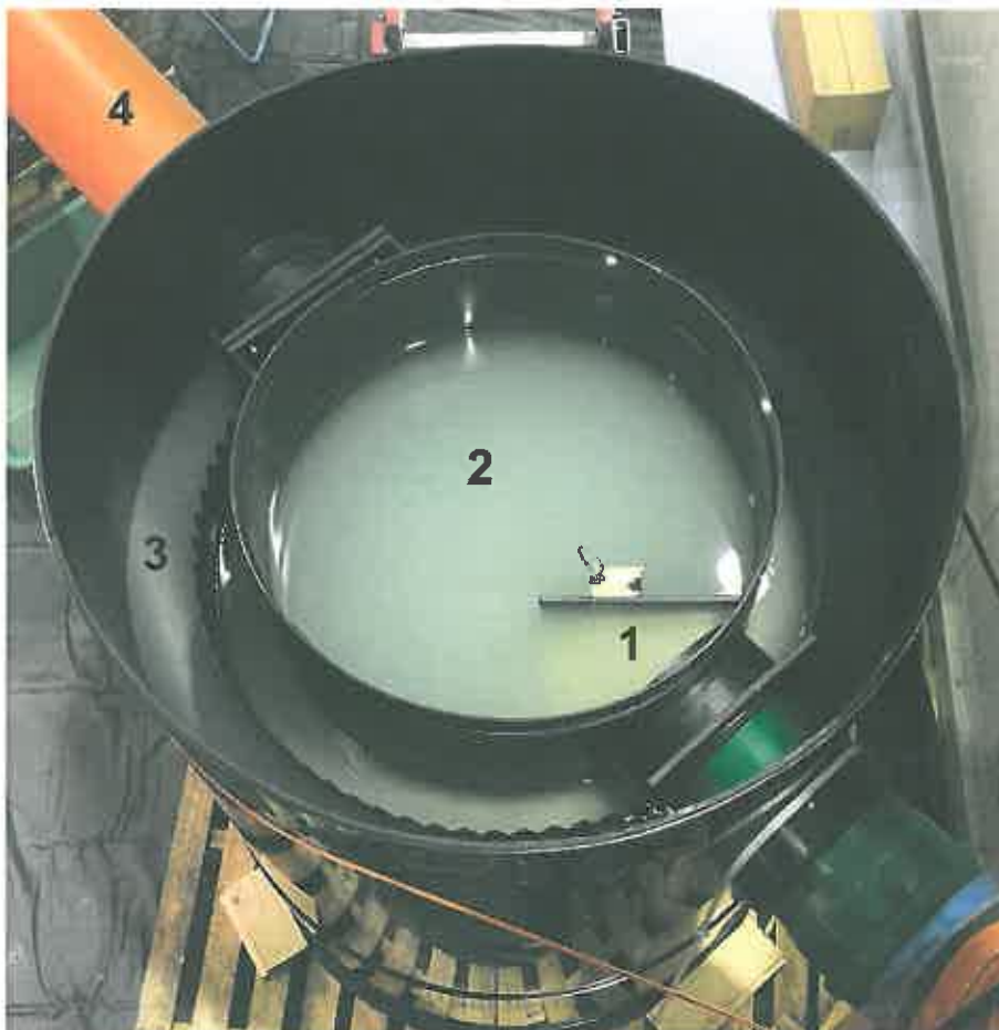
Abb. 2: Blick in den Hydroshark mit den einzelnen Komponenten: Zulauf (1), Absetzbereich (2), Zackenwehr (3) sowie Auslauf (4).
